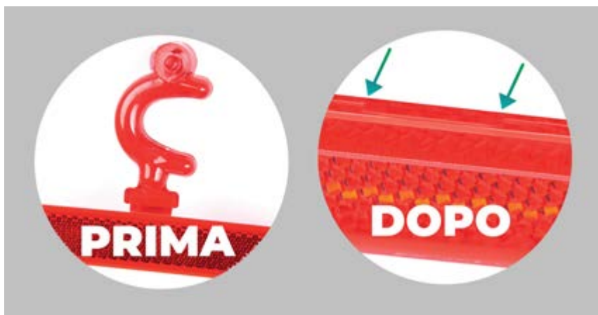
Punto di separazione prima e dopo l'integrazione del taglio materozza: il bordo risulta più uniforme e definito direttamente dal processo, senza interventi di rifinitura a valle
