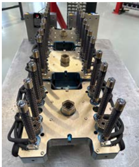
Esempio di canale caldo Witosà di cui fanno parte gli ugelli Monolith e le rondelle di contrasto Energy Blocker
