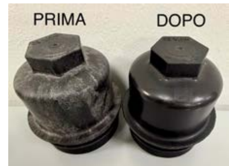
Dettaglio prima e dopo l'utilizzo della tecnologia a canali caldi Witosa distribuita da Ermanno Balzi
