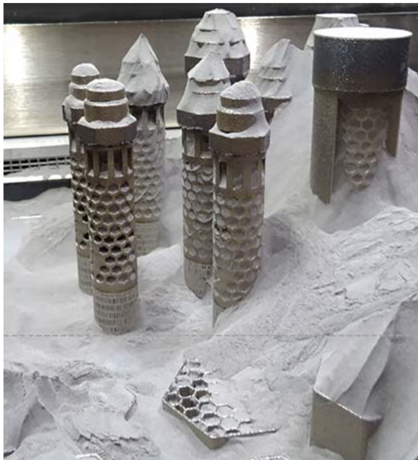
figura 1 - Tecnologia SLM applicata alla produzione di ugelli e rondelle di contrasto
