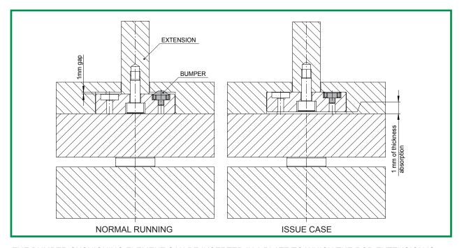
THE BUMPER CUSHIONING ELEMENT CAN BE INSERTED IN A PLATE TO WHICH THE ROD EXTENSION IS ATTACHED. IN CASE OF PLASTIC INTRUSION UNDER THE LIFTER BLADE, THE BUMPER SYSTEM WILL ABSORB THE TENSION IN THE MECHANICAL ELEMENTS OF THE LIFTER, PRESERVING ITS INTEGRITY.
