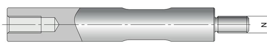
LE PROLONGATEUR CODE PFC.. PEUT ÊTRE RACCOURCI A LA LONGUER NÉCESSAIRE ET TARAUDÉ A L'ARRIÈRE COMME MONTRÉ SUR LE SCHÉMA.
