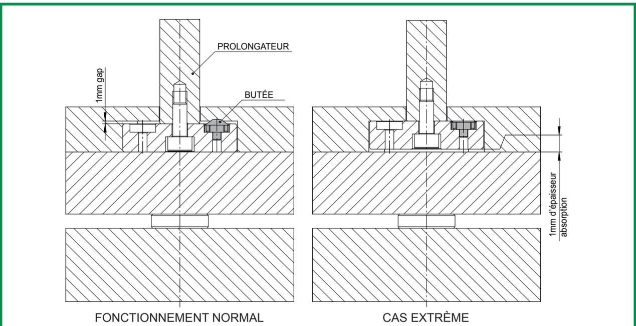
LA BUTÉE D'AMORTISSEMENT PEUT ÊTRE INSÉRÉE DANS UNE PLAQUE À LAQUELLE LE PROLONGATEUR EST FIXÉ. EN CAS D'INTRUSION DE PLASTIQUE SOUS LA CALE, LE SYSTÈME DE BUTÉE ABSORBE LA TENSION DANS LES ÉLÉMENTS MÉCANIQUES DE LA CALE ÉJECTRICE EN PRÉSERVANT SON INTÉGRITÉ.
