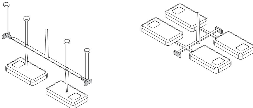
Avec l'utilisation de l'ECOVENT, une grande surface d'événation des gas est mise en place à l'extrémité du canal froid permettant ainsi que les gas produits lor du malaxage de la matière s'échappent par l'intermédiaire du système au d'aller dans l'empreinte.
