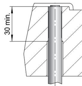
Certains matériaux polymères produisent un volume important de gaz pendant le processus de malaxage et dosage. Les dépôts de gaz huileux peuvent s'empiler et obstruer les canaux d'évacuation du gaz. Il est dans ce cas conseillé de prévoir un canal d'évacuation de gaz supplémentaire dans le moule tel qu'illustré sur l'image pour améliorer la performance de la valve.
